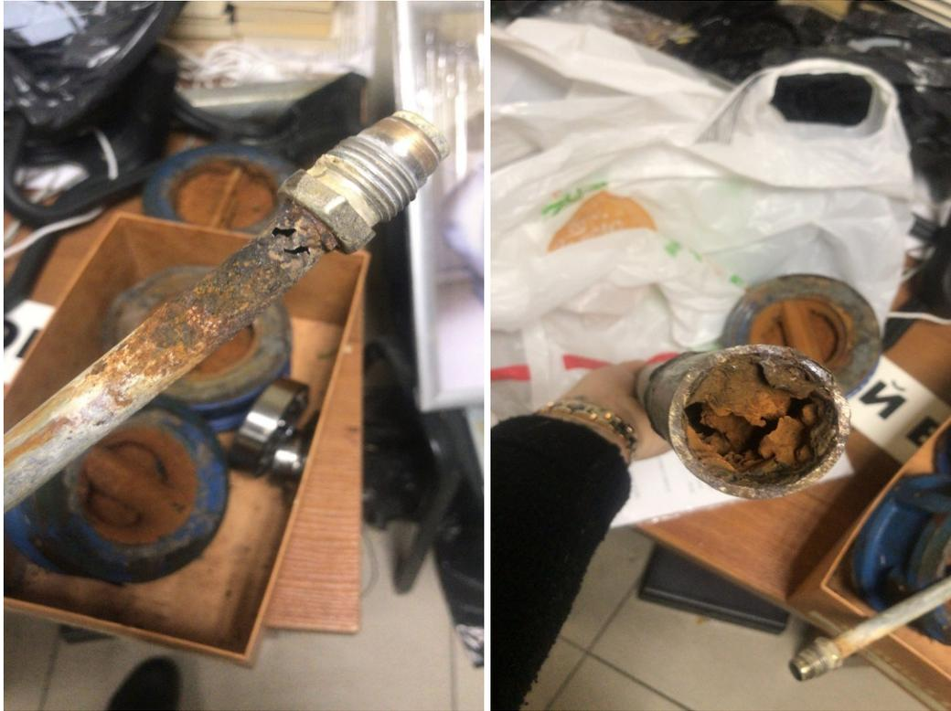
Трубы ГВС и ХВС, в следствие коррозионного процесса, имели крайне высокую степень зарастания, что привело к низкой циркуляции, снижению температурного режима и плохому качеству воды.
